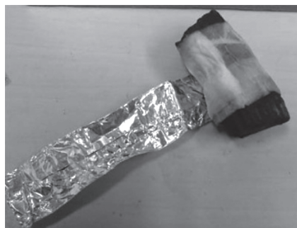
図 12 備長炭電池の組み立て
