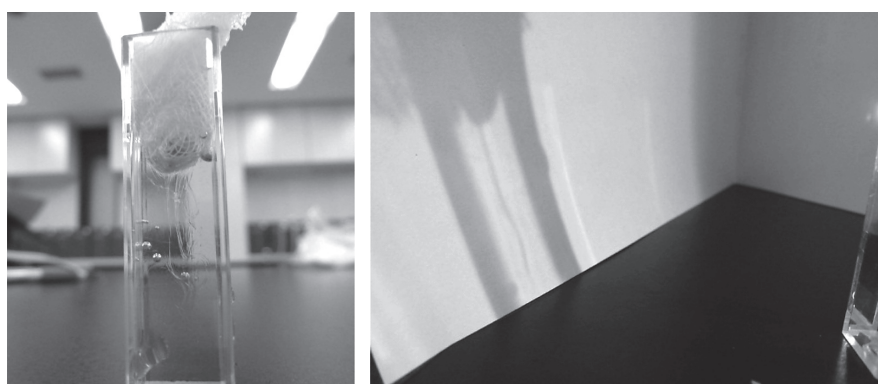
図6 左:分光セルを用いたシュリーレン現象の観察 右:照明によりシルエットで観察
