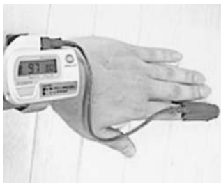
図1：パルスオキシメーターのセンサーを人差し指に、本体を腕に装着しているところ。
